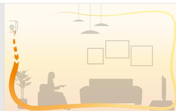
L'effetto Coanda indirizza il flusso d'aria a seconda della modalità di funzionamento. In raffreddamento il flusso è orizzontale e in riscaldamento è verticale.
